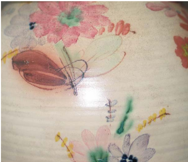
Kuva 3. Ara-maljakon koristemaalauksesta yksityiskohta. Mattapintainen lyijylasite on värjätty peittäväksi titaani- ja tinaoksidien yhdisteellä.
