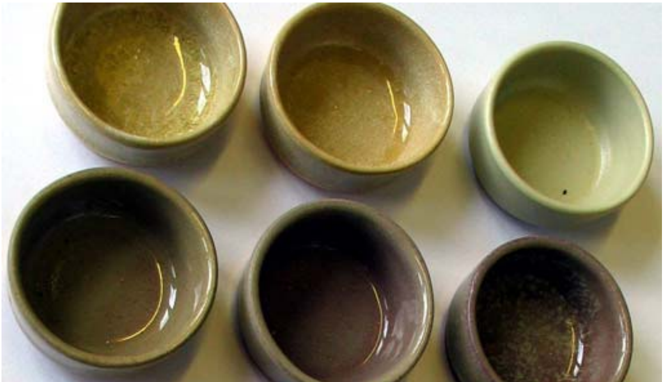
Kuva: Matalapolton valetut kuppinäytteet lasitettuina. Booraksisulate lasitteessa muuttaa värin sinipunertavaksi (kaksi alinta oikealla)
