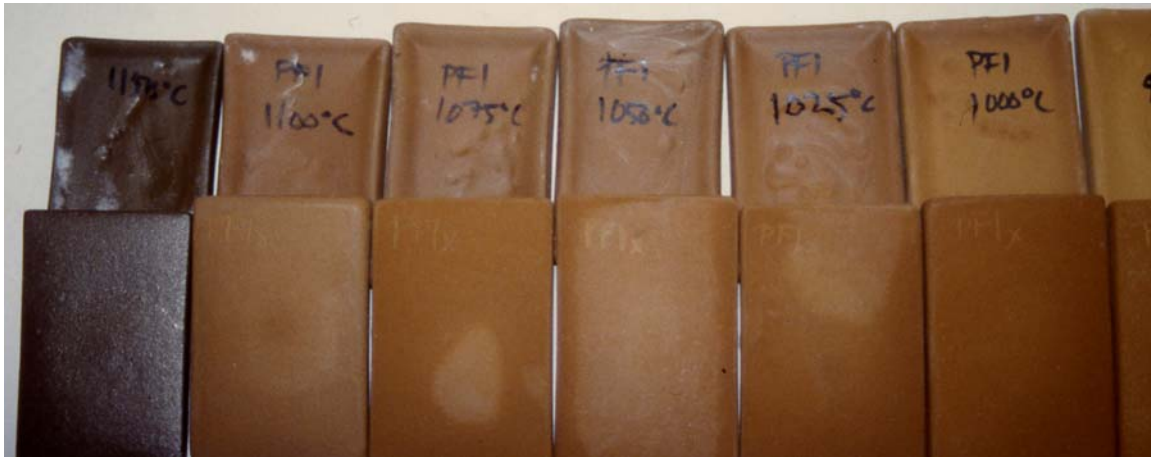
Kuva. Näytelevyt massasta PF1 on poltettu gradientti 950-1150°C, oikealta vasemmalle.
