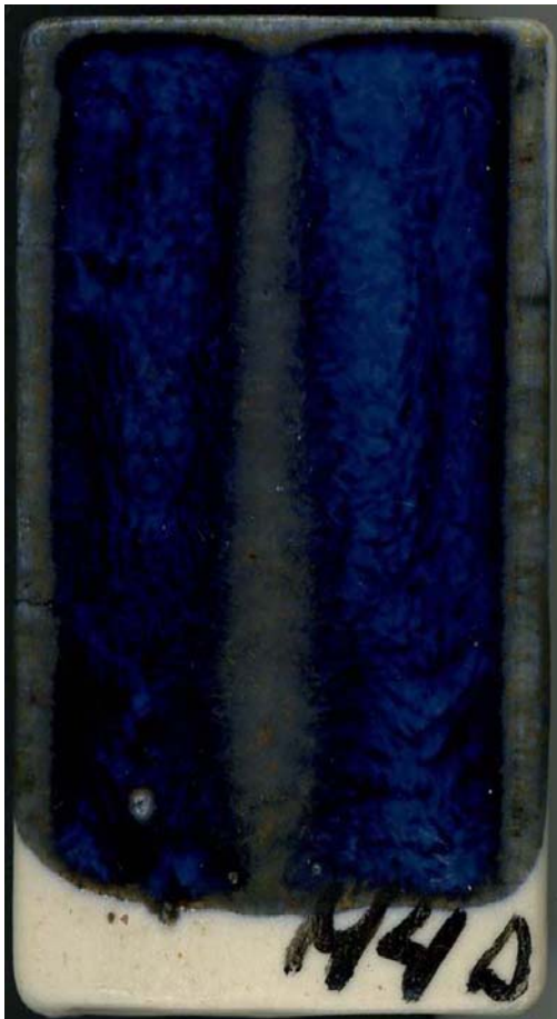
A. Hortling. Kuvassa kivitavaralasiite M4, joka on värjätty kolmen värimetallioksidin seoksella: Kobolttioksidi 1 % + rautaoksidi 3 % + titaanidioksidi 2 %. Lasite valuu pois keskellä olevalta kohoumalta jättäen pinnan himmeäksi. Lasite M4 (A. Hortling) Kalimaasälpä 20 %, liitu 15 %, sinkkioksidi 15 %, dolomiitti 5 %, boorisulate P2953 17 %, kaoliini 8 %, kvartsi 20 %. Polttolämpötila 1200°C.
