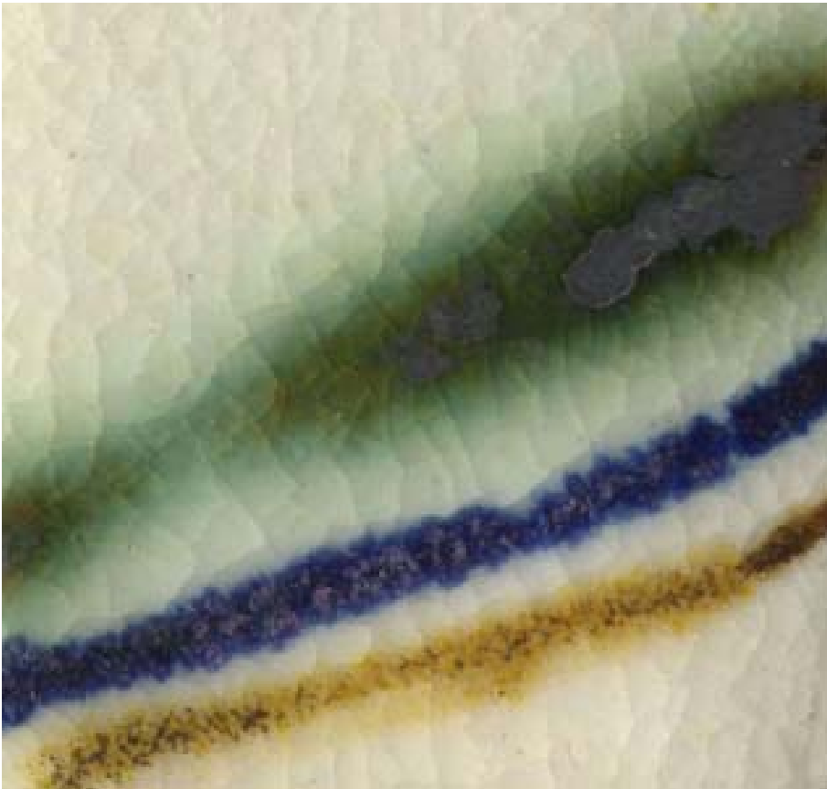
Kuva 10: LK4 lasite, alin rautaoksidi ( \text{Fe}_2\text{O}_3 ) viiru, keskellä kobolttioksidi (CoO) viiru ja ylinnä kuparioksidi (CuO)viiru, valkoinen huokoinen massa.
