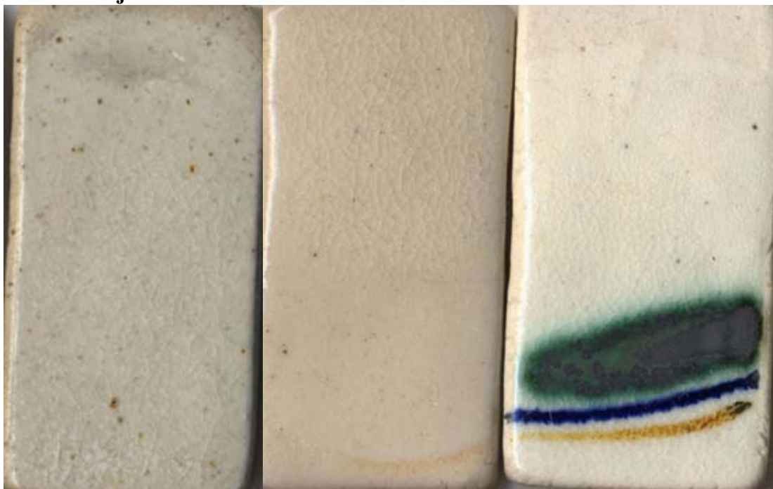
Kuva 23: Lasite LK7 (vasen) harmaa kivitavaramassa ja LK8, harmaa kivitavaramassa ja valkoinen huokoinen massa. Viiruvärit vihreä, kuparioksidi (CuO), sininen kobolttioksidi (CoO) ja punaruskea rautaoksidi (Fe 2 O 3 ) 1200°C.
