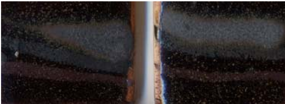
Kuva 19: Lasite LK6, harmaa kivitavaramassa. Viiruvärit ovat (ylin) metallinen mustaharmaa kuparioksidi ( \text{CuO} ), (keskellä) siniharmaa kobolttioksidi ( \text{CoO} ) ja (alin) punaruskea rautaoksidi ( \text{Fe}_2\text{O}_3 ) 1200^\circ\text{C} .
