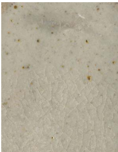
Kuva 24: Lasite LK7 kivitavaramassa. Yksityiskohta ohuen ja paksun lasitteen rajakohdasta, 1200°C. Massaan on sekoitettu punasavipulveria n. 2-3%, mikä näkyy pisteinä. Punasavi kiehuu ja muodostuu reikä lasitteen pinnan läpi. Reiän ympäritys värjäytyy rautaoksidin vaikutuksesta kellertäväksi. Väriefekti lisää pisteen vaikutusta.
