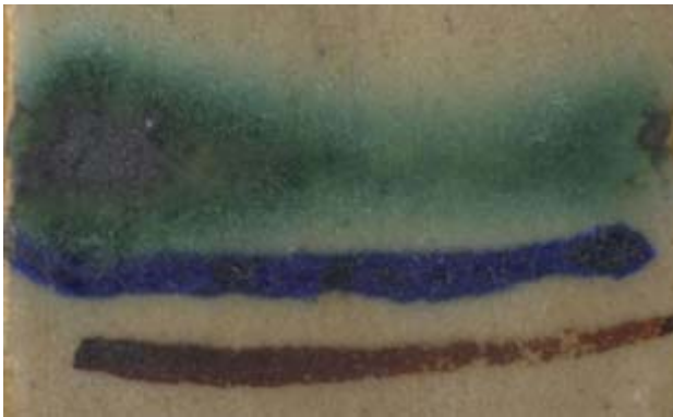
Kuva 3: Lasite LK1 1200°C, alin viiruväri on tumman ruskea rautaoksidi (Fe 2 O 3 ), keskellä sininen kobolttioksidi (CoO) ja ylin on vihreä kuparioksidi (CuO), höyrystyy ja leviää ympäristöön
